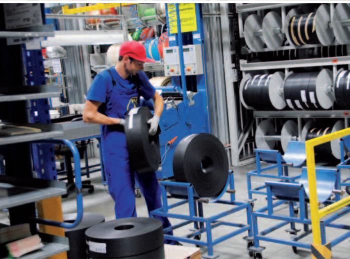
**Die möglichen Beläge** lagern in Form großer Rollen in einem Aufzugregal. Ein Mitarbeiter bringt sie für die einzelnen Skier in die richtige Länge.
