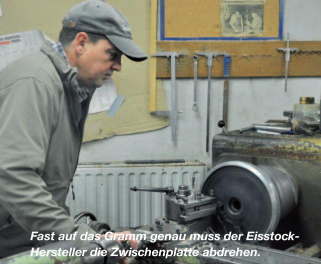
*Fast auf das Gramm genau muss der Eisstock-Hersteller die Zwischenplatte abdrehen.*
